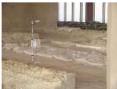
Fig. 3. Villa di età romana ad Ascoli Satriano (FG): monitoraggio delle superfici a mosaico con unità Grillo MMTS connesse ad OLINDA
